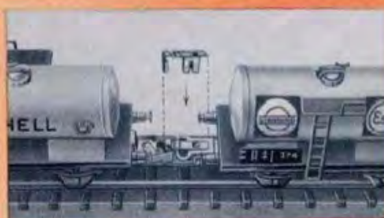
Wagen 374 S mit normaler Kupplung und Wagen 374 StK mit neuer automatischer Kupplung durch Zusatzkupplung 360 ZK miteinander verbunden
