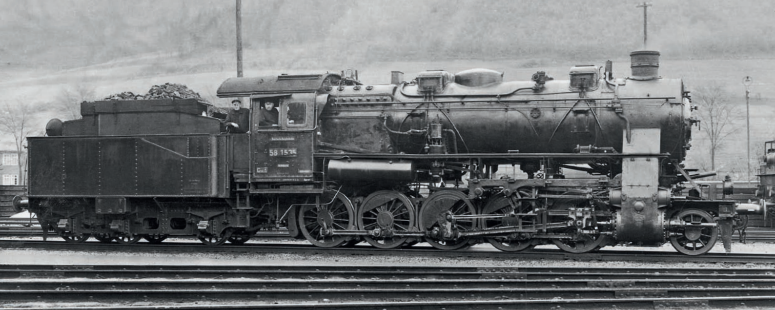
Stolzer Lokführer und Heizer: An der Lok der BR 58.10-21 fallen der 3-achsige Tender auf, der Belpaire-Stehkessel, die hohe Kessellage und das Triebwerk.
