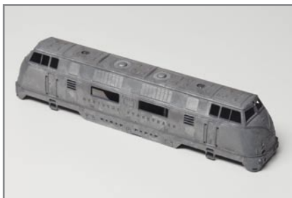
Im Phosphorsäurebad entsteht eine zwei Mikrometer dünne Schicht aus Zinkphosphat.
