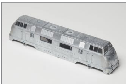
Vor der Phosphatierung wird die Materialoberfläche des Zinkdruckguss-Teils in Bädern gereinigt.
