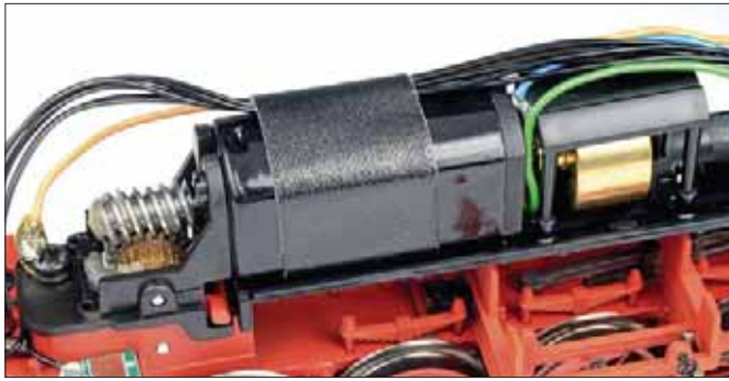
Der Motor liegt im Kessel und hat vorn eine Schwungmasse und hinten eine stählerne Schnecke, die über ein Stufenzahnrad ihre Kraft ...
