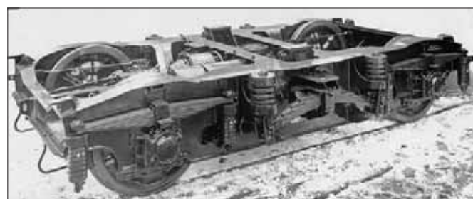
Unten: Eines der Laufgestelle des VT. Deutlich erkennbar ist die vierfache Federung. Fotos: Werkfoto Wumag, Slg. Theurich
