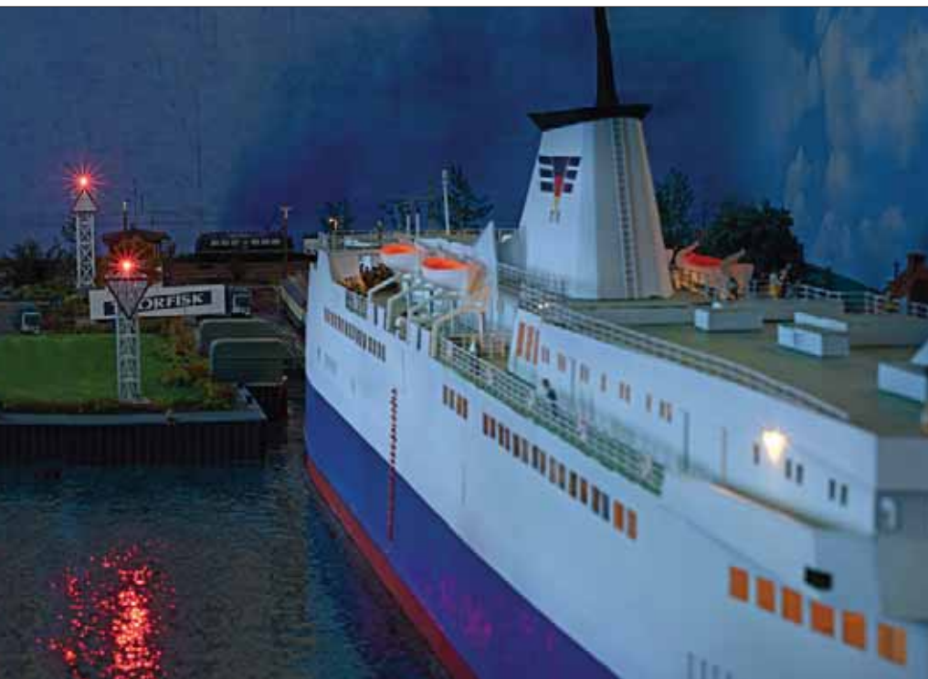
Die Richtfeuerlinie besteht aus Unter- und Oberfeuer, durch entsprechende dreieckige Baken gekennzeichnet. Fotos: Martin Knaden
