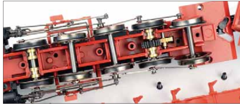
... auf die vierte Kuppelachse überträgt. Erste und vierte Kuppelachse tragen Haftreifen, die anderen Achsen lagern gefedert im Rahmen.
