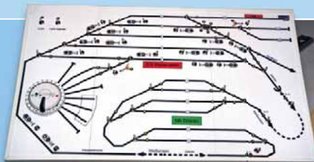
Das große Gleisbildstellpult zeigt die Hauptstrecke inklusive der verdeckten Strecken und der Schattenbahnhöfe.
