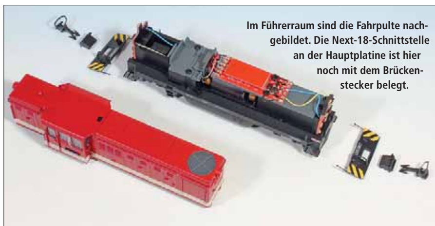
Die Gehäusebefestigung erfolgt über Zapfen an der Frontschürze und Löcher im Rahmen und am Gehäuse.
