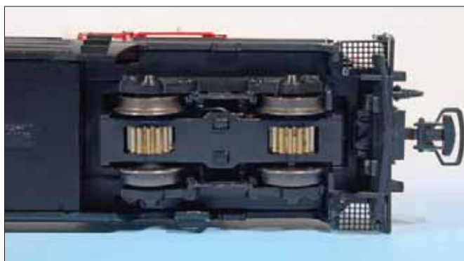
Der Kupplungsträger verbindet Schürze und Rahmen zusätzlich miteinander. Die seitenbewegliche Kupplung befindet sich als Steckteil im Kupplungsträger.
