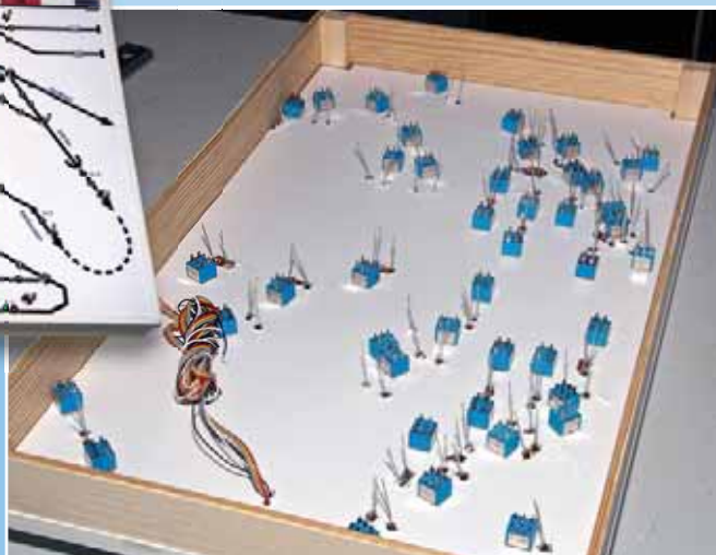
Noch prägen die Gehäuse der Kippschalter und die Beinchen der LEDs die Unterseite des Gleisbildstellpults.
