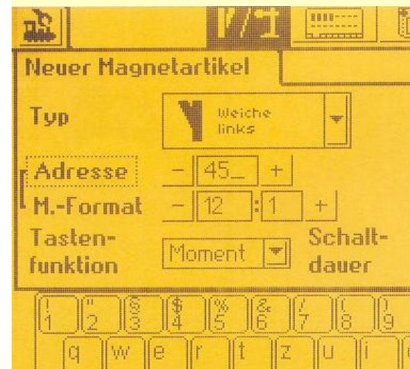
Het adres kan bij het Central Station vrij worden gekozen van 1 tot 256.
