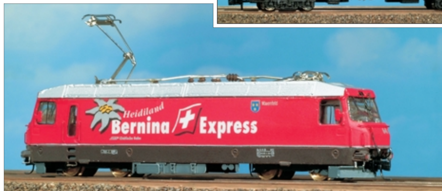
Nm: Schlossers Ge 4/4 III der RhB mit Glockenankermotor und Schwungmasse.
