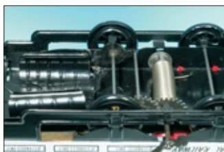
2: Paya nimmt die Nostalgie ernst: In der Straßenbahn steckt ein Federantrieb, mit dem das Gefährt rasselnd seine Runden dreht. Für die Beleuchtung lässt sich eine Batterie einsetzen.
