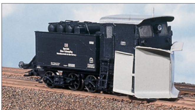
H0: Henschel-Schneepflug der Bauart „Klima“ mit beweglichen Schilden und funktionierendem Arbeitsscheinwerfer.
