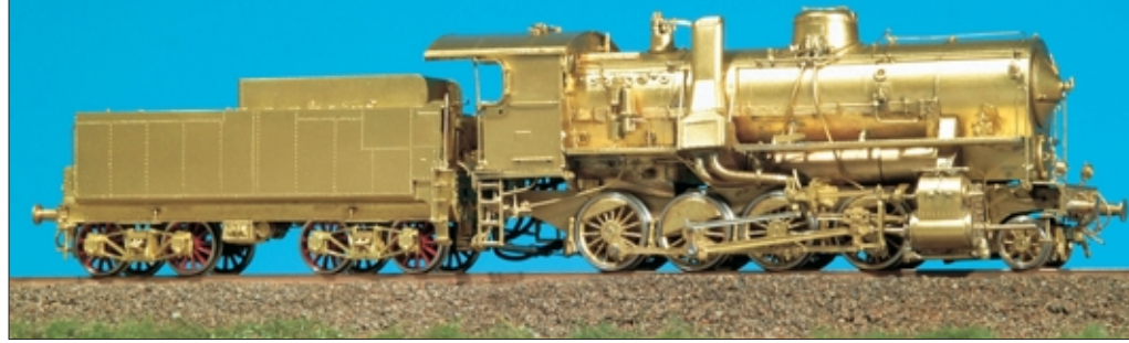
H0: Schlepptenderlok der FS-Reihe 741 von Top-Train mit Walschaerts-Steuerung.
