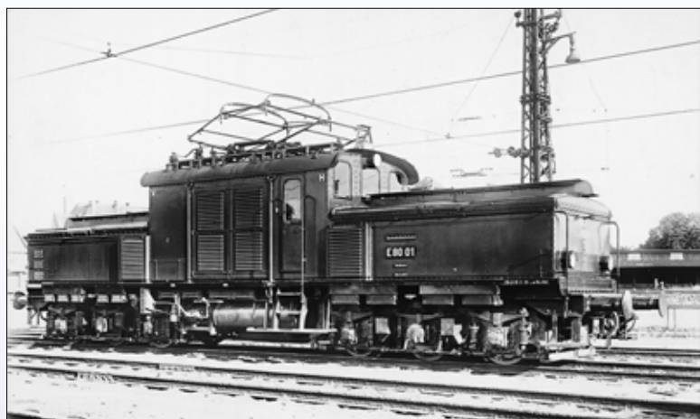
Die interessante E 80, die sowohl aus dem Fahrdrabt als auch aus Akkus gespeist werden konnte. Für den Modellbahner heißt das, er kann die Lok auch gänzlich ohne Oberleitung fahren lassen.
