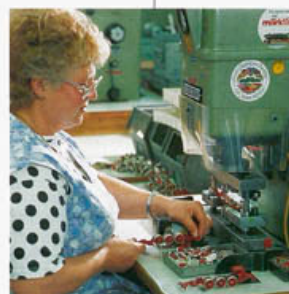
Montage der Fahrgestelle
