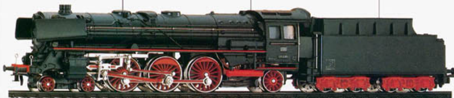
Art.-Nr. 3193 Schnellzuglokomotive mit Schlepptender · Modell der Baureihe 01 der Deutschen Bundesbahn mit der Achsfolge 2'C1' · 3 Achsen angetrieben · 2 Haftreifen · Nachbildung der Heusinger-Steuerung · Fernsteuerung für Vor- und Rückwärtsfahrt · Beleuchtetes Dreilicht-Spitzensignal · Mattschwarzes Metallgehäuse · Fahrgestell aus Zinkdruckguß · Am Tender Kupplungshaken · Eingerichtet für Rauchsatz (Märklin-Nr. 7226) · Länge über Puffer 28 cm
