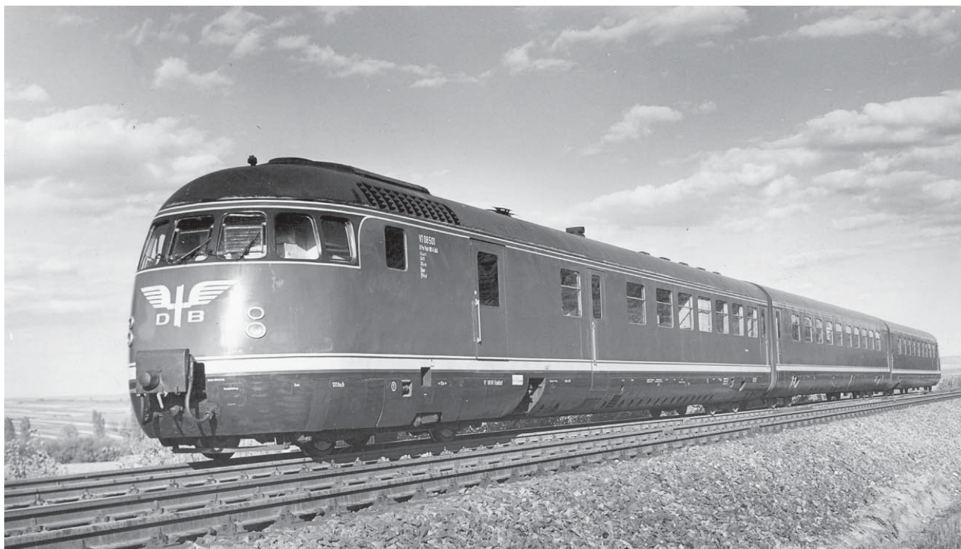
Ein Triebzug, bestehend aus Trieb-, Mittel- und Steuerwagen.
