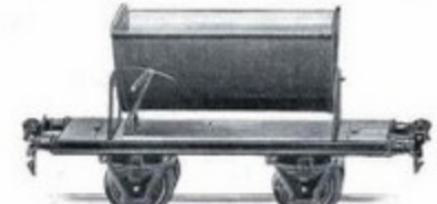
1972 Kippwagen , 2achsiger Kippkasten beweglich nach 2 Seiten entleerbar, mit Sperrvorrichtung 1972/0 Spur 0: 13 cm lang, 1972/1 Spur 1: 20 cm lang 1.90 3.—
