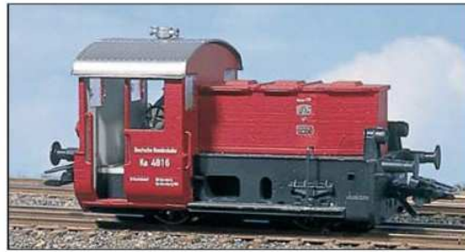
Ein eher seltenes Modell ist die Akku-Kleinlok der DB-Baureihe Ks. Das Modell der Baureihe 602 (mit Gasturbine) ist mit mehreren Digitalfunktionen ausgestattet.
