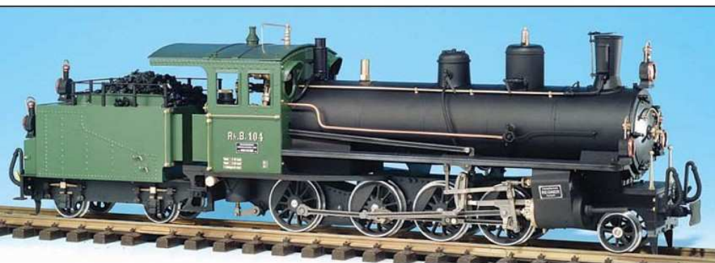
2m: Lok 104 der RhB wird als Live-Steam-Modell von Regner angeboten. Die Maschine ist wie alle „lebenden“ Dampfzöcher aus Aurach solide aus Stahl und Messing gefertigt. 2m (unten): „Willi“ und „Konrad“ sprechen vornehmlich den Dampfzöcher an und kommen daher „ready-to-run“ aus der Verpackung.
