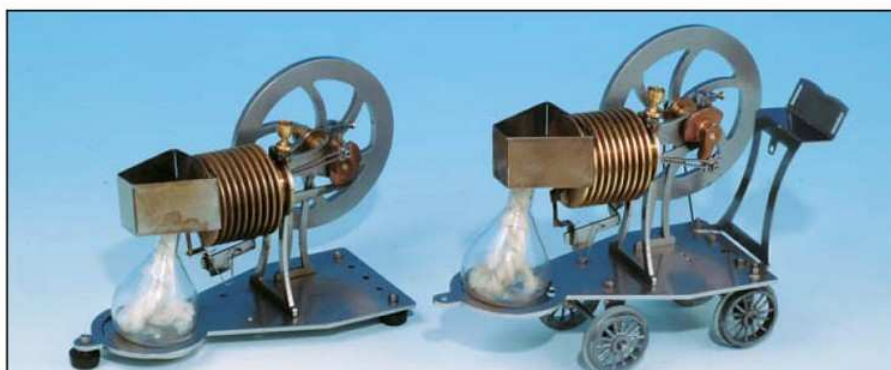
2m: Der „Feuerfresser“ von Hielscher kann wahlweise stationär oder als Draisine für Gleise mit 45 mm Spurweite verwendet werden.
