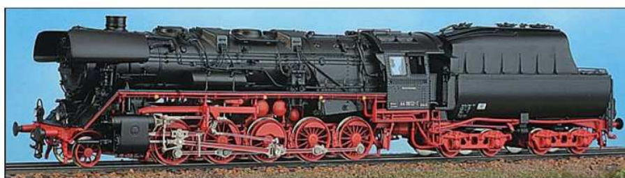
H0: 44 9612 ist mit einem Einkammer-Staub-Wannentender gekuppelt.
