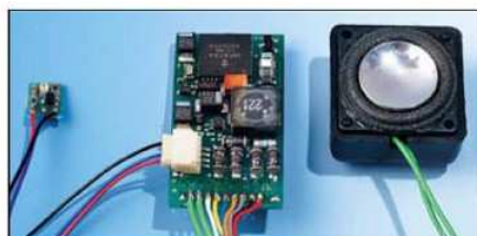
Uhlenbrocks Decoder mit Sound und anschließbarem LISSY-Sendemodul
