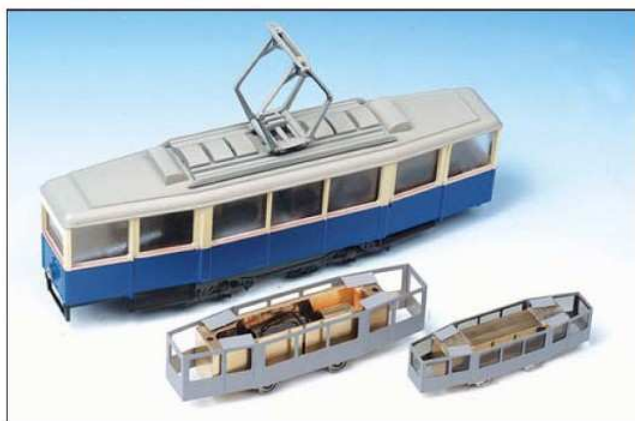
N/Z: KSW-Straßenbahnen wurden von Hödl angekündigt. Die Kleinserienmodelle, bestehend aus Messing- und Neusilber-Ätzteilen, werden sowohl mit einem Glockenankermotor als auch mit einem Digitaldecoder, der auch analog betrieben werden kann, ausgestattet sein.
