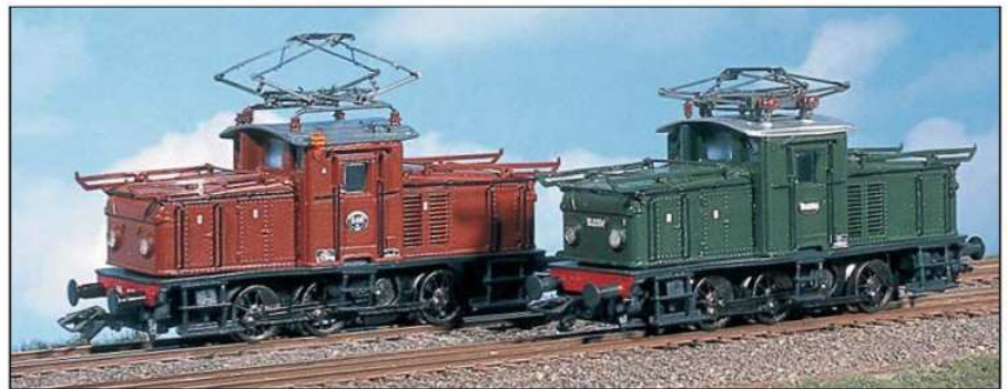
Die Modelle der Rangierloks Ub der SJ (links) und El 10 der NS besitzen Miniaturmotoren mit Schwungmasse und damit gute Rangiereigenschaften.
