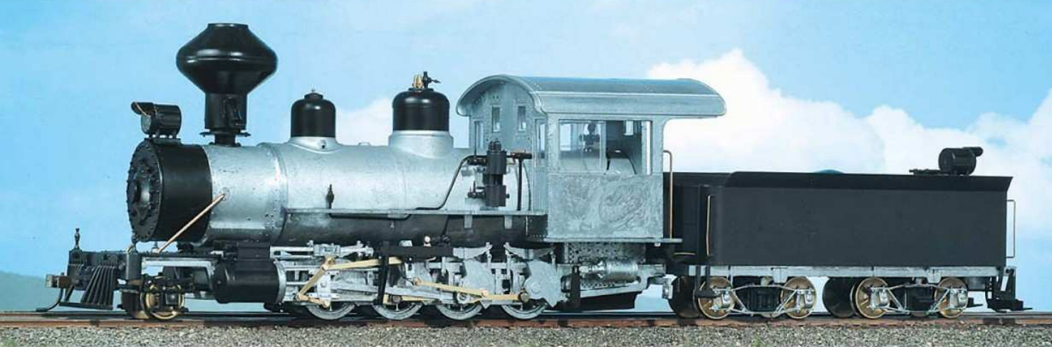
On30: Das Handmuster der amerikanischen 1'D-Schmalspurlok mit Außenrahmen und Hall'schen Kurbeln macht von der Detaillierung her schon mal einen guten Eindruck.
