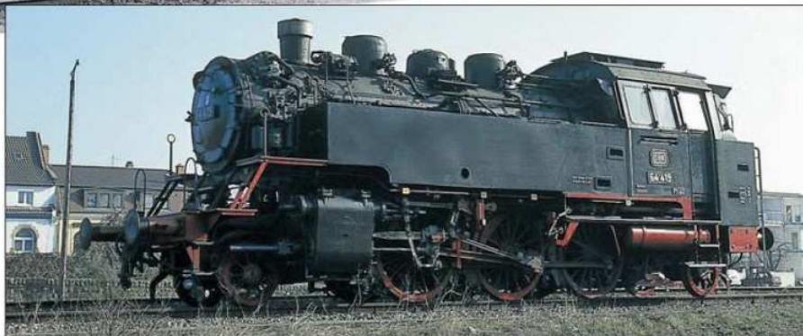
H0: Die BR 64 kommt als Neukonstruktion mit geschweißten Wasserkästen. Foto: MK
