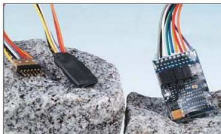
2-N: Der bekannte „LokPilot“ von Esu erhielt völlig neu entwickelte Nachfolger. Der „LokPilot micro“ sollte dabei mit seinen Abmessungen von 13,5 x 9 x 3 mm bestens in Loks der Baugröße N Platz finden.
