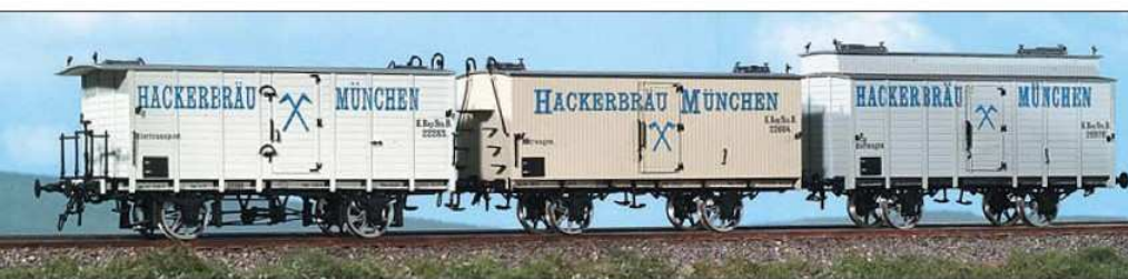
H0: Drei verschiedene bayerische Abteilwagen in der Lackierung und Beschriftung um 1880. H0: Die drei Bierwagen liefert Bavaria im Set. Die Wagen sind alle unterschiedlich: einer besitzt einen Dachaufsatz (für Eis), einer einen Bremserstand.
