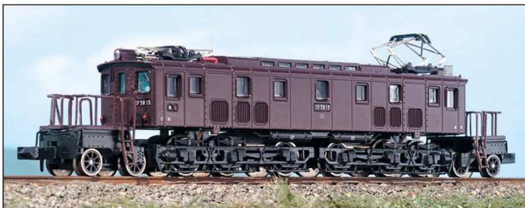
N: Microace bietet eine moderne Hochleistungslokomotive und einen Ellok-Oldtimer aus Japan an. Beide Modelle, mit fünfpoligen Motoren und Schwungmassen ausgestattet, besitzen gute Laufeigenschaften.
