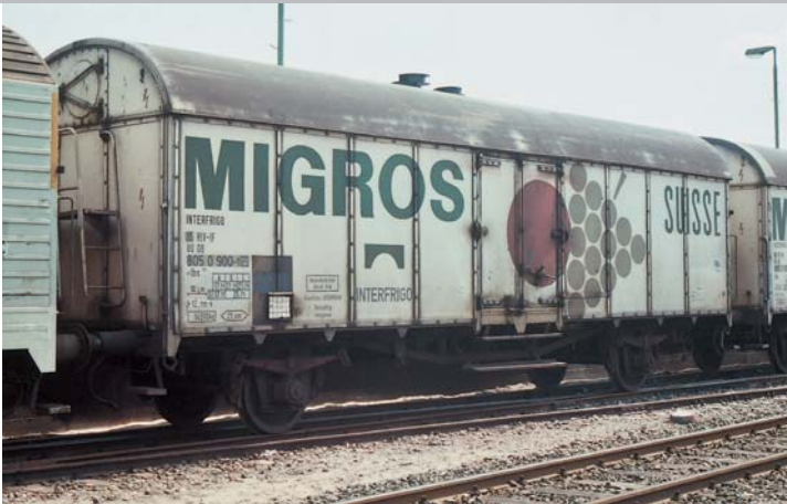
Am 13. Juli 1982 standen diese beiden DB-Kühlwagen Ibs 394 (ehemals Tnomehs 35) mit UIC-Betriebsnummern, die von der INTERFRIGO an MIGROS vermietet waren, an der Bananenkaje des Kaiserhafens in Bremerhaven. Die unterschiedliche Seitenwandgestaltung mit farbigen Obst- und Gemüsemotiven ist gut zu erkennen. Beim Vorbild handelt es sich um »Nachfolger« des Insider-Jahreswagens.
