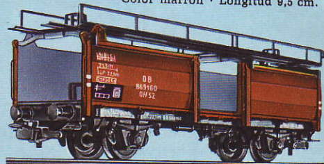
4612 Vagón para el transporte de automóviles con puente de carga · Sin carga · Color marrón, puente negro · Longitud 11,5 cm. · (Los ferrocarriles Federales Alemanes acoplan siempre 2 vagones para formar una unidad con la denominación Off 52)
