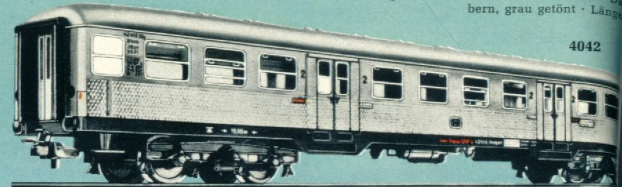
4043 Nahverkehrswagen · 4-achsig · Modell der Deutschen Bundesbahn (AB 4 nb) · Abnehmbares Dach · Eingesetzte Fenster mit plastischen Rahmen · Wagenkasten in der Farbe rostfreien Stahls mit Pfauenaugenmuster · Dach silbern, grau getönt · Vorbildgetreue Beschriftung · Länge 24 cm
