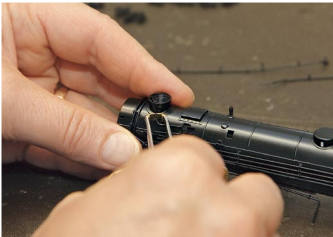
Aufwendige Details: Viele Anbauteile werden manuell angebracht.
