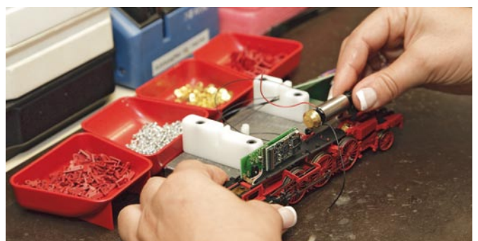
Der Glockenanker-Motor sitzt später unter dem Druckguss-Kessel.
