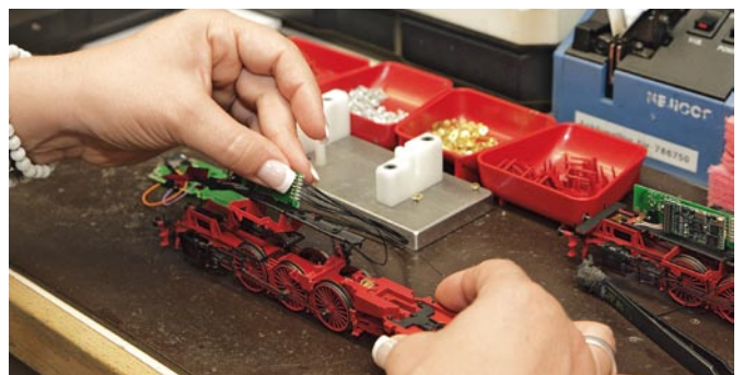
Sorgfältig wird die Platine mit der Elektronik auf das Unterteil gesteckt.
