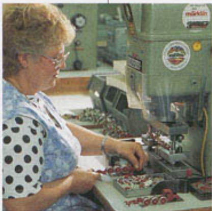
Montage der Fahrgestelle
