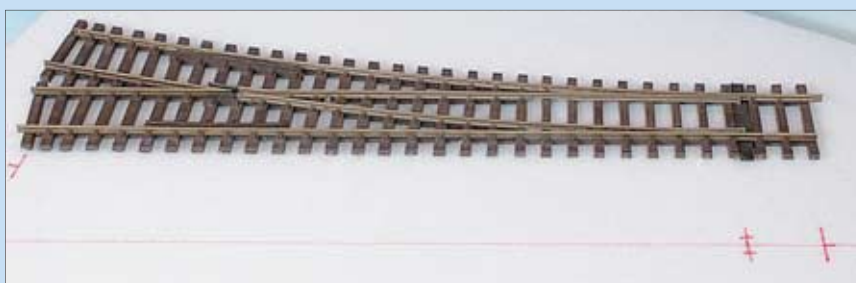
1. Weiche auflegen und Bohrung unterhalb der Stellschwelle markieren.
