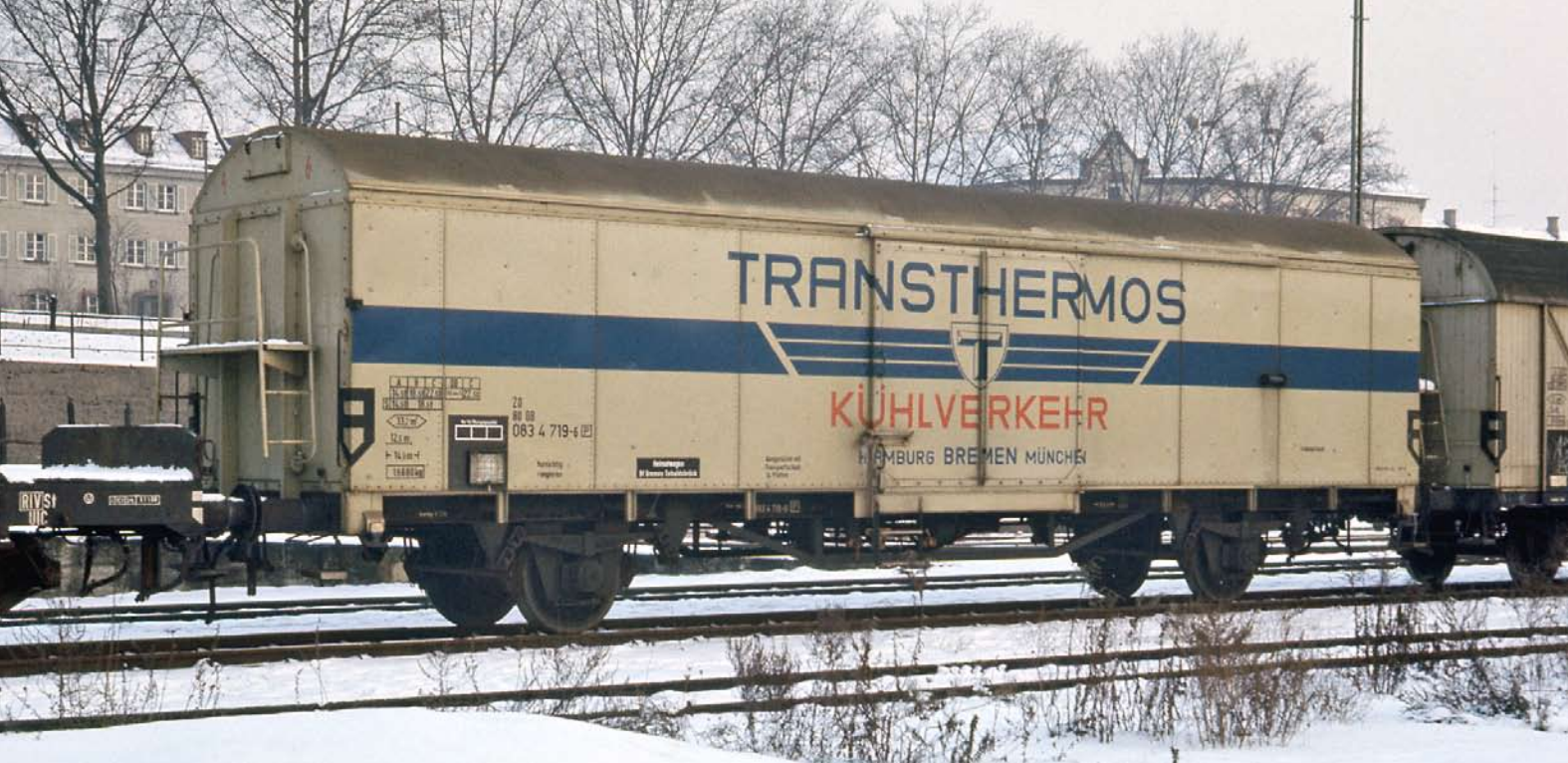
Insider-Jahreswagen in H0: Den mächtigen Kühlwagen der Bauart Ibbpls 379 mit Arbeitsbühne und Trockeneis-kanal hatte Transthermos von der DB gemietet.
