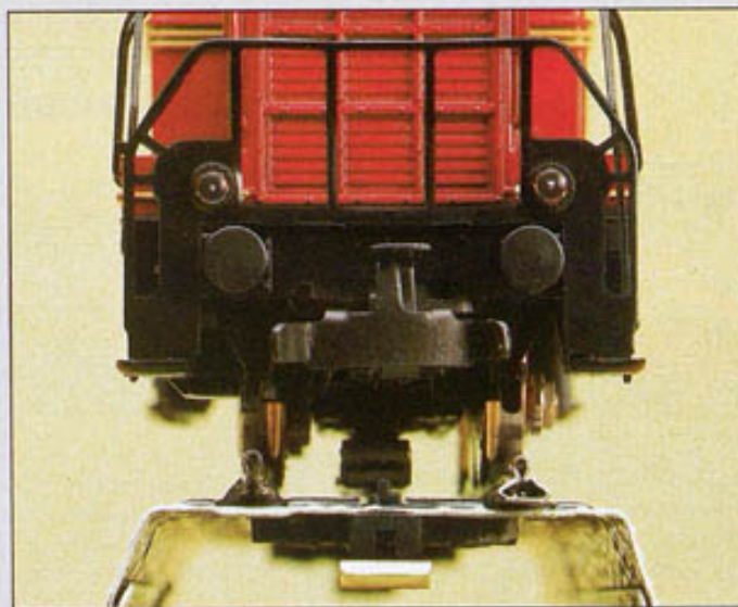
Die Auflage des Schleifers auf mehreren Punktkontakten gewährleistet ständig sichere Stromübertragung zum Antriebsmotor der Lokomotive.
