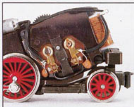
Der robuste und zugkräftige Motor der Primex-Lokomotiven ist für die Wartungs- arbeiten leicht zugänglich.
