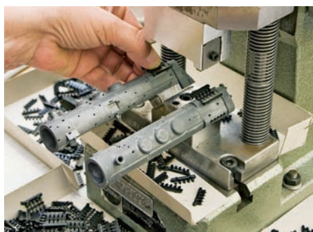
Mit einem Schnittwerkzeug werden die am Spritzling befestigten Waschlukn gleichzeitig eingepresst und abgetrennt.
