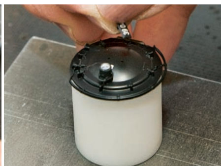
Das Einsetzen des fertig bedruckten Nummernschildes in die Rauchkammertüre erfolgt mit Hilfe einer Vorrichtung.
