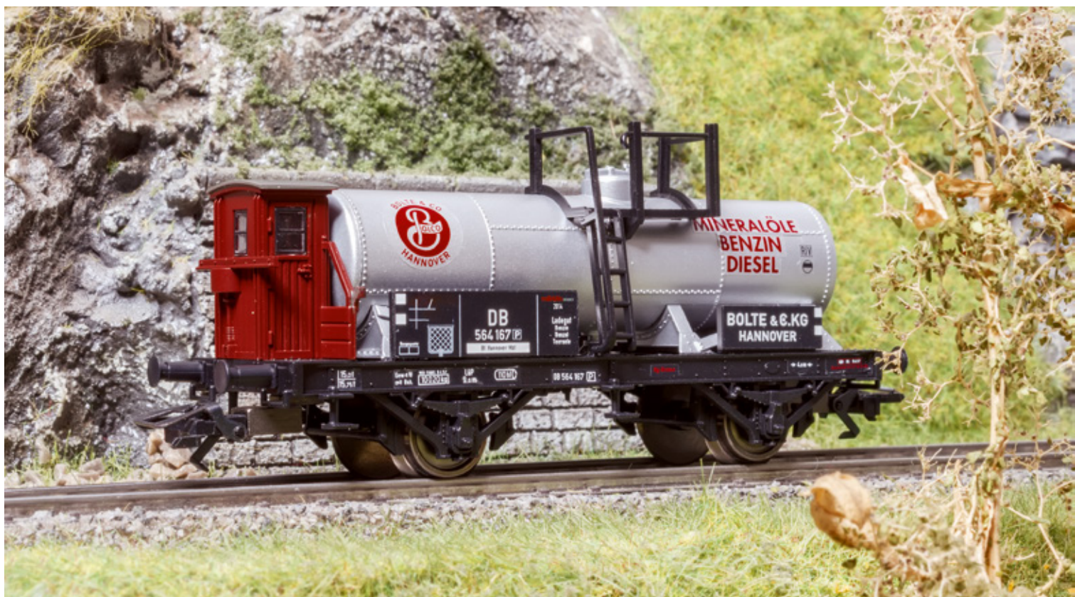
Insider-Jahreswagen 2014 in H0: Der Privatwagen für Mineralölprodukte der Firma Bolte besitzt ein Bremserhaus bayerischer Bauart und Achshalter aus der Länderbahnzeit.
