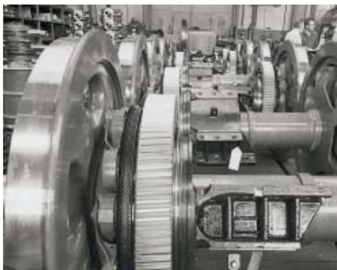
unten: Eine Reihe Achsen stehen zum Einbau bereit. Gut erkennbar ist der Gummi- ring-Kardantrieb.
