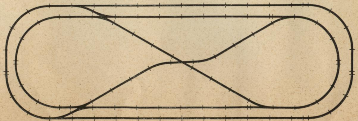
Abb. 3600/611 Doppeltes Gleis-Oval mit mehreren Kehrschleifen unter Verwendung doppelter Kreuzungsweichen
