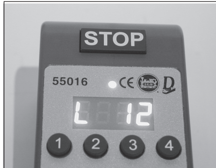
Abb. 5.33: Mit dem Lok-Handy kann man nur die Adressen 00 bis 15 programmieren.
