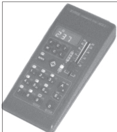
Abb. 3.90: Auch das Fahrpult MX2 wird über den CAN-Bus angeschlossen.
