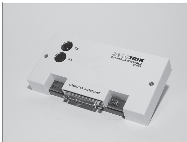
Abb. 3.74: Das Selectrix-Interface schafft Übertragungsraten von bis zu 19.200 Baud.
