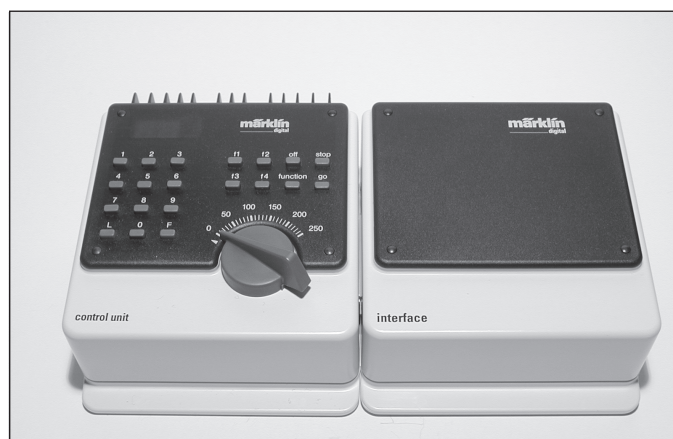
Abb. 3.50: Central Unit und Interface – mehr braucht man als PC-Modellbahner bei Märklin Digital nicht zum Glücklichen sein. Das beiliegende Kabel führt zum PC.
