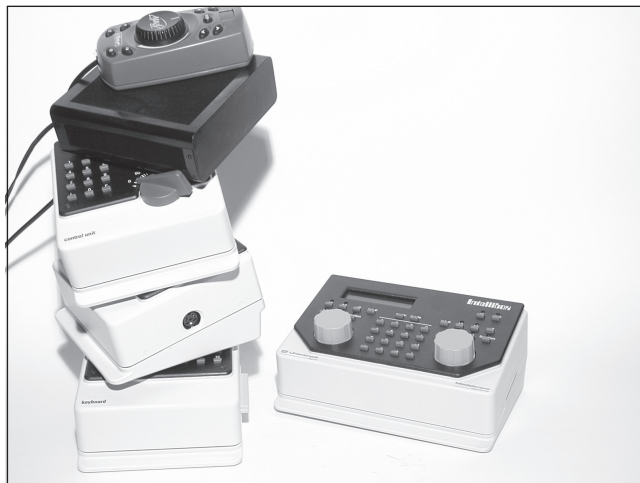
Abb. 3.78: All in One (alles in einem): All diese Geräte stecken in der Intellibox (rechts)
