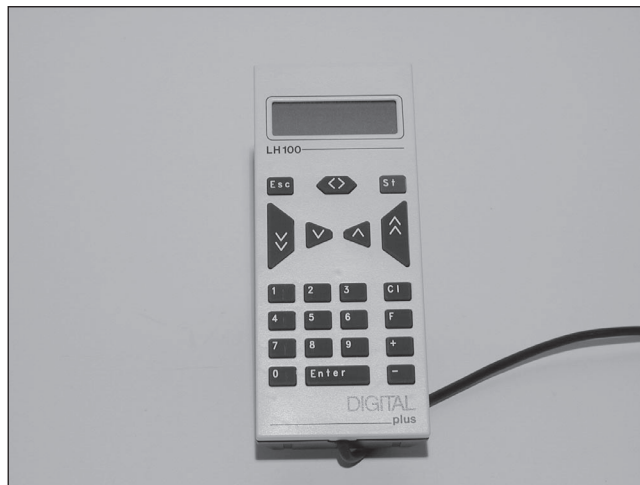
Abb. 3.17: Der Handregler LH100 hat ein informatives Display – aber keinen Drehregler.
