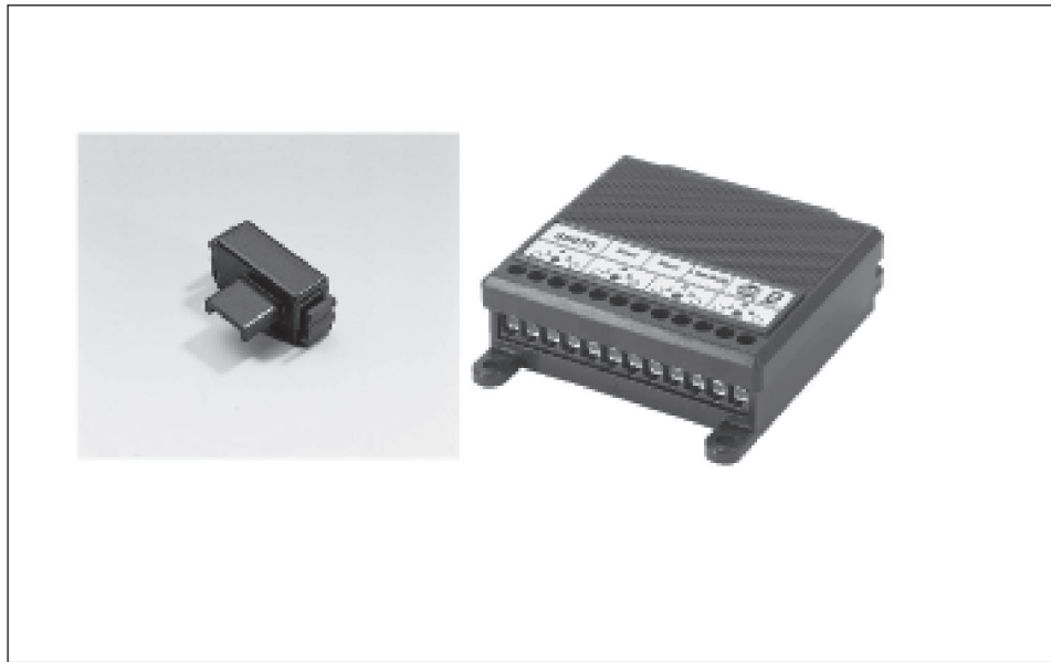
Abb. 3.39: Rückmeldemodule und Gleiskontakte oder Gleisbesetzmelder und Trenngleise braucht man, um dem Computer Infos zukommen zu lassen.
