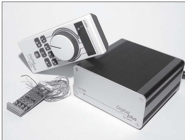
Abb. 3.23: Zum Set 03 gehört der Handregler LH200, ein Booster und ein Lokdecoder.
