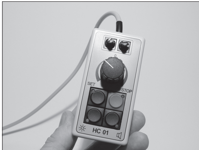
Abb. 3.56: Beim Regler HC01 von Digirail wird die Lokadresse per Drehschalter eingestellt.
