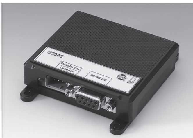
Abb. 7.8: Das Programmiermodul von LGB programmiert Lok- und Weichendecoder.
