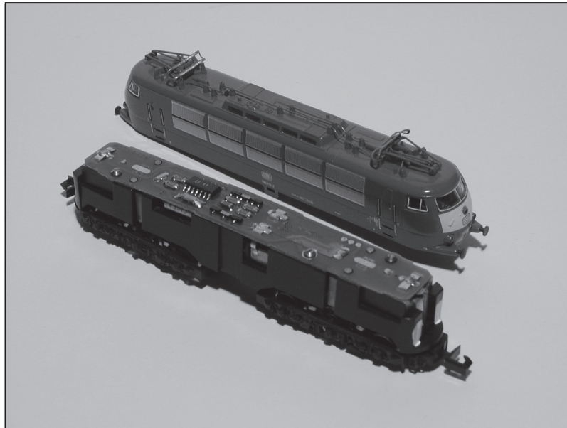
Abb. 2.9: Auch das gibt es: In dieser Lok von Arnold wurde der Decoder bereits ab Werk eingebaut und ist fester Bestandteil der Lok.
