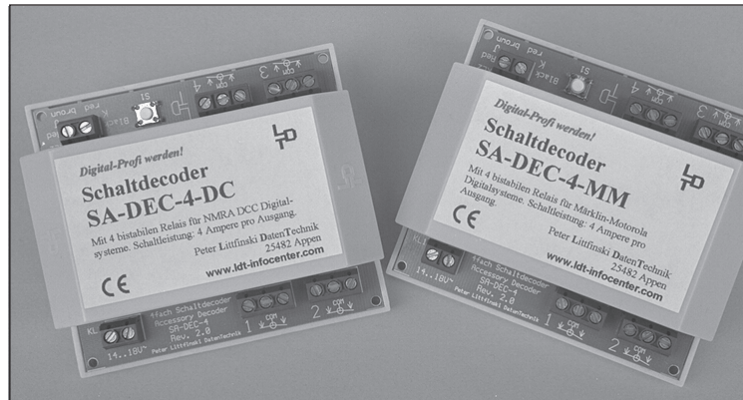
Abb. 2.14: Mit einem Schaltdecoder wie dem SA-DEC-4 von LDT lassen sich Beleuchtungen und Motoren schalten. Man kann mit ihm aber auch ganze Gleisabschnitte abschalten.
