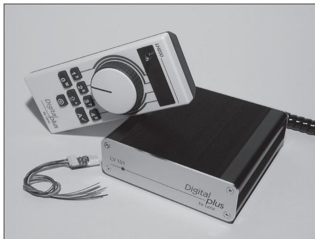
Abb. 3.21: Set 02 besteht aus einem Handregler und einem Leistungsverstärker.
