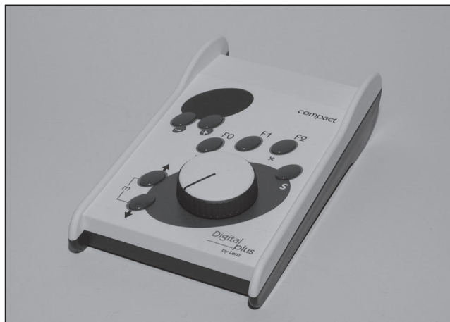
Abb. 3.24: Das Compact ist ein kleines Digitalsystem in einem Gehäuse.
