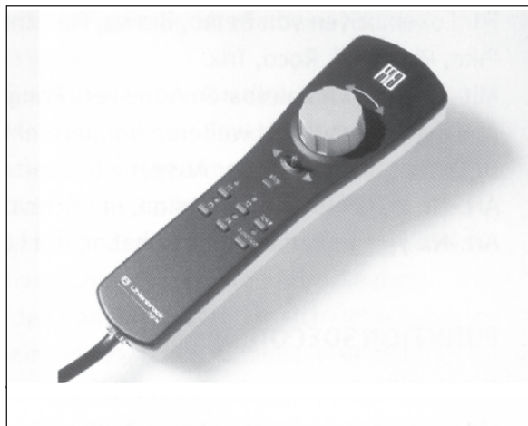
Abb. 3.85: Auf den Namen FRED hört der Handregler von Uhlenbrock, der via LocoNet an die Intellibox angeschlossen wird.
