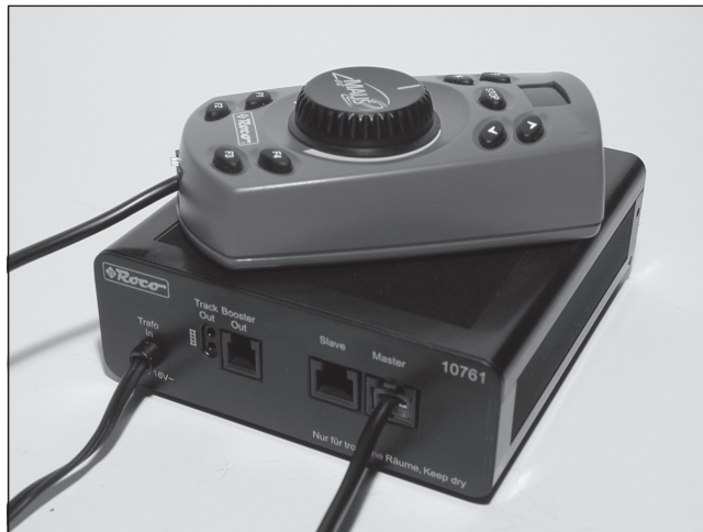
Abb. 3.60: Die Lokmaus wird als „Master“ an den Verstärker angeschlossen. Weitere Lokmäuse arbeiten dann als „Slaves“.
