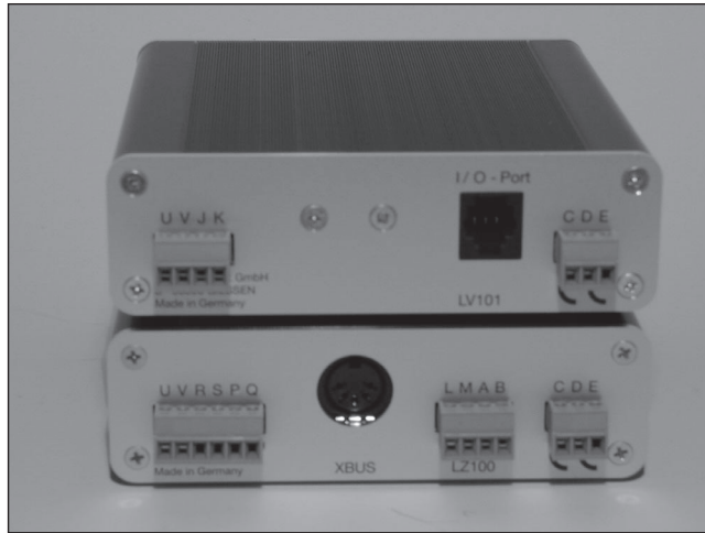
Abb. 3.14: Zentrale LZ100 und Booster LV101 von hinten – die drei XpressNet-Anschlusstypen existieren zurzeit noch nebeneinander.
