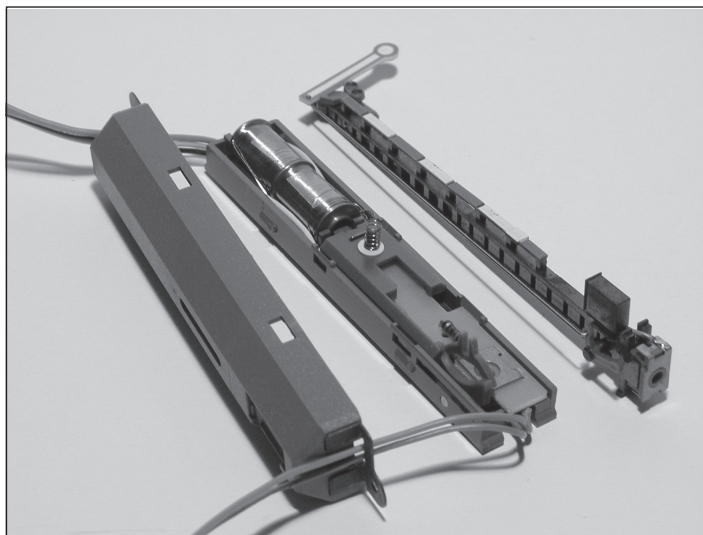
Abb. 2.10: So sehen typische Magnetartikel wie Weichen- oder Signalantrieb und Entkuppler von Innen aus.
