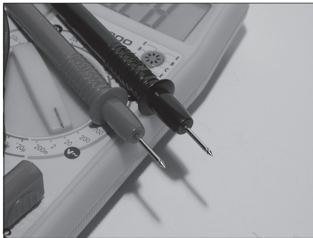
Abb. 5.3: Die Enden der Messkabel sind meistens mit Metallstiften versehen.
