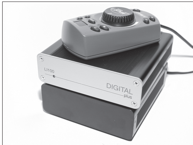
Abb. 3.65: Auch das PC-Interface LI100F von Lenz versteht sich prächtig mit dem Roco-System.
