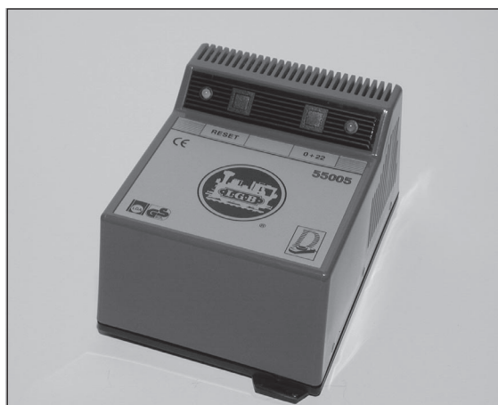
Abb. 3.26: Die MZS-Zentrale „Typ 2“ sieht auf den ersten Blick aus wie ein Transformator.
