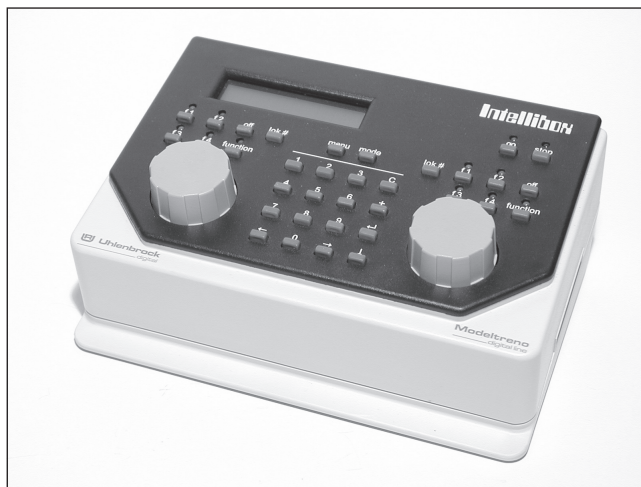
Abb. 3.77: Die Intellibox vereint eine Fülle an Funktionen in einem Gehäuse. Auch einen Computer kann man über das eingebaute Interface anschließen.
