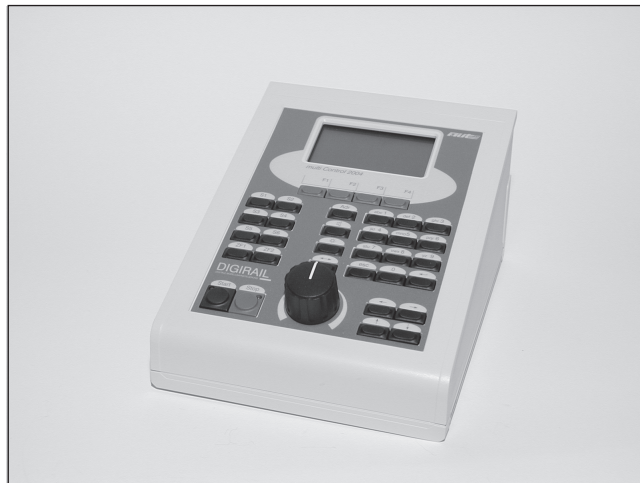
Abb. 3.5: Die „multi control 2004“ von MÜT/Digirail verwendet auch das Selectrix-Format.
