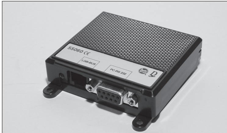
Abb. 3.35: Das Interface von LGB ist nicht wetterfest und gehört unter ein Dach.
