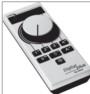
Abb. 3.22: Der Handregler LH200 arbeitet auf Wunsch auch als Zentrale.
