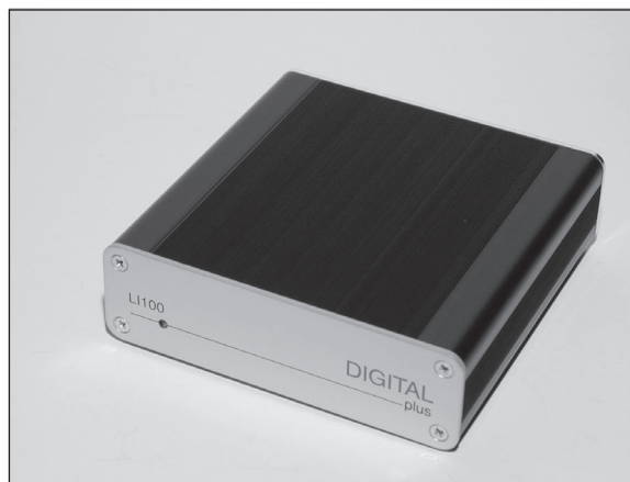
Abb. 3.20: Das Interface LI100F stellt die Verbindung zwischen Zentrale und PC her.
