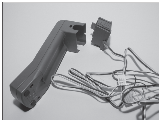
Abb. 5.34: Das Programmier-Modul muss ins Universal-Handy geschoben werden.
