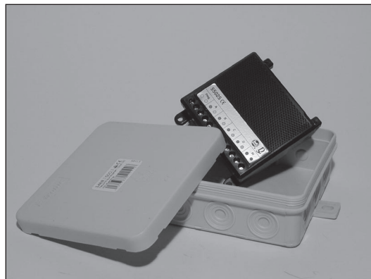
Abb. 3.34: Die wasserdichten Weichendecoder kann man ideal in Verteilerkästen aus Kunststoff unterbringen, wie man sie im Baumarkt kaufen kann.
