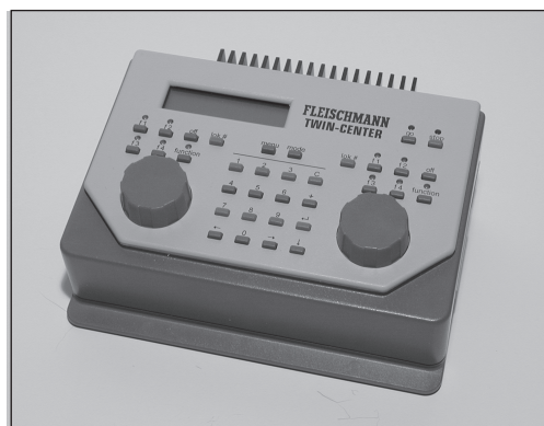
Abb. 3.9: Das neue Twin-Center von Fleischmann basiert auf einer Intellibox.
