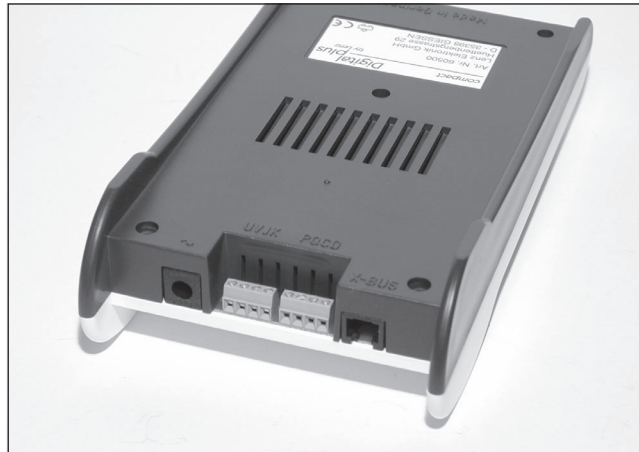
Abb. 3.25: Die Anschlüsse des Compact liegen an der Unterseite des Gehäuses.
