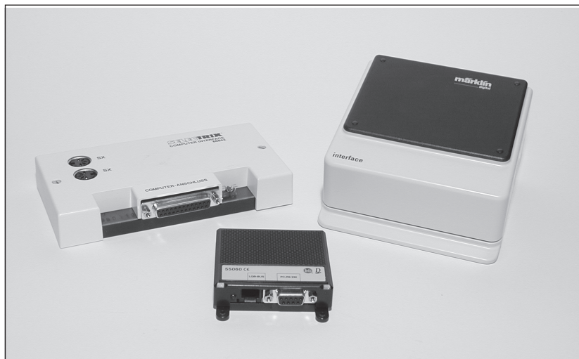
Abb. 2.22: Ein Computer-Interface vermittelt zwischen dem steuernden Computer (meistens ein PC) und der Digital-Zentrale. Je nach Hersteller sieht es völlig anders aus.
