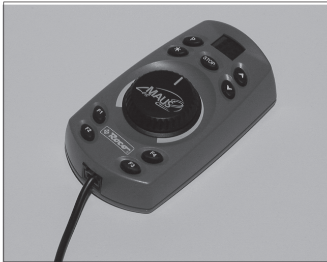
Abb. 2.6: Beim Digitalsystem von Roco passt die Zentrale ins Gehäuse des Handreglers, der so genannten „Lokmaus 2“.
