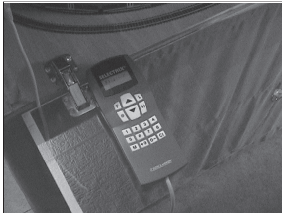
Abb. 3.70: Das Control-Handy erweitert das System auf 100 Adressen.
