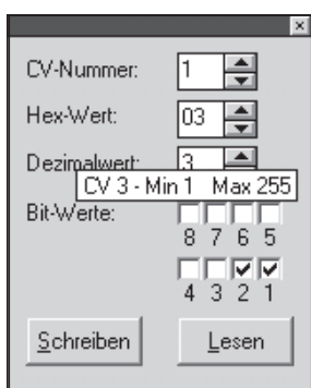
Abb. 7.4: Der Decoder kann auch direkt programmiert und getestet werden.
