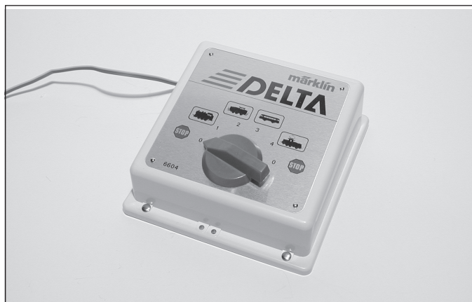
Abb. 3.45: Das DELTA Control ist eine Digitalzentrale für den digitalen Einstieg.
