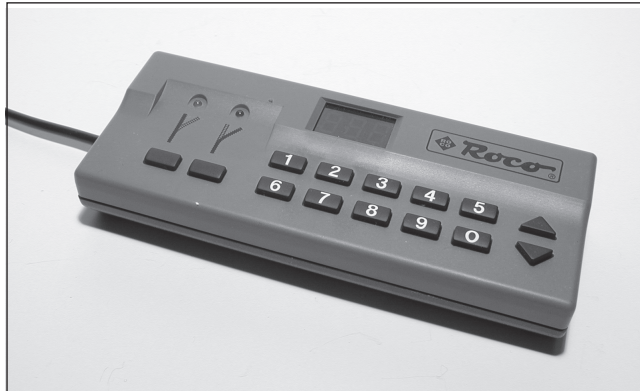
Abb. 3.63: Das Weichenkeyboard schaltet bis zu 256 Magnetartikel.
