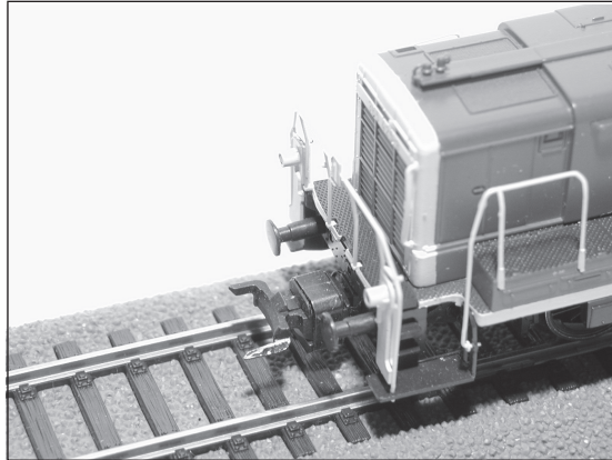
Abb. 3.67: Die rote BR365 hat eine digital – auch vom PC – bewegliche Kupplung
