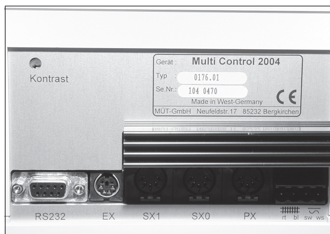
Abb. 3.54: An der Rückseite der Zentrale befinden sich sechs Anschlüsse.
